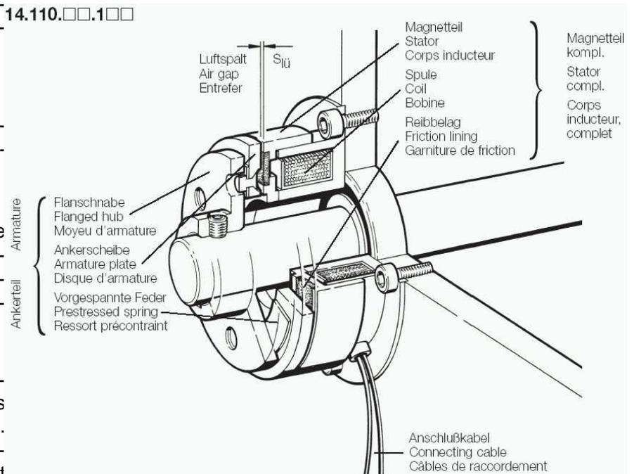
Beim Ankerteil „1“ mit Flanschnabe (siehe Bild) erfolgt das Befestigen über den Gewindestift. Beim Ankerteil „3“ wird die Ankerscheibe über die Membrane direkt am zu bremsenden Teil angeschraubt.
